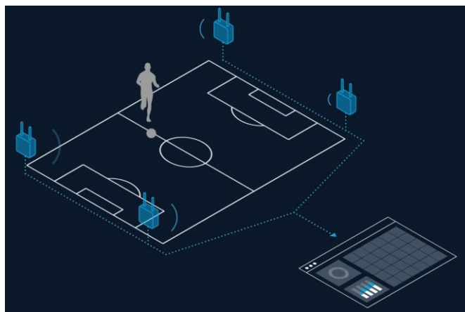
Рисунок 1 – Схема работы системы Kinexon при проведении соревнований по гандболу
